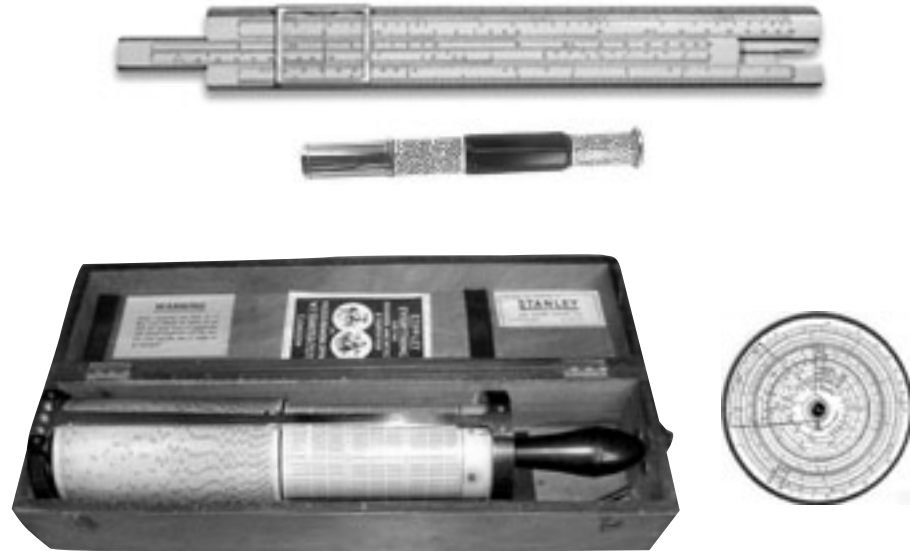
Rysunek 1. Suwaki logarytmiczne: prosty, cylindryczny, na walcu i okrągły
