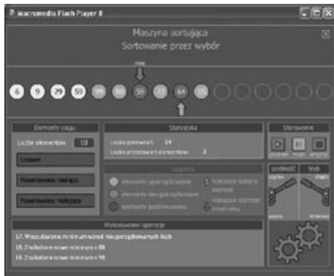
Rysunek 8. Demonstracja działania algorytmu porządkowania przez wybór w programie Maszyna sortująca – cztery pierwsze elementy znajdują się już na swoim miejscu w ciągu uporządkowanym i szukany jest najmniejszy element w pozostałej części ciągu, by przenieść go na miejsce piąte
