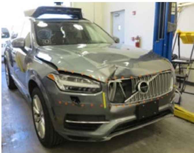
Rysunek 2. Widok pojazdu testowego Uber z uszkodzeniami prawej części przodu po zderzeniu (źródło: „Preliminary Report Highway: HWY18MH010” )
